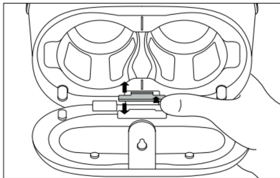
如图所示，调整手机位置，确保手机屏幕中间定位线与设备定位线保持对齐。
