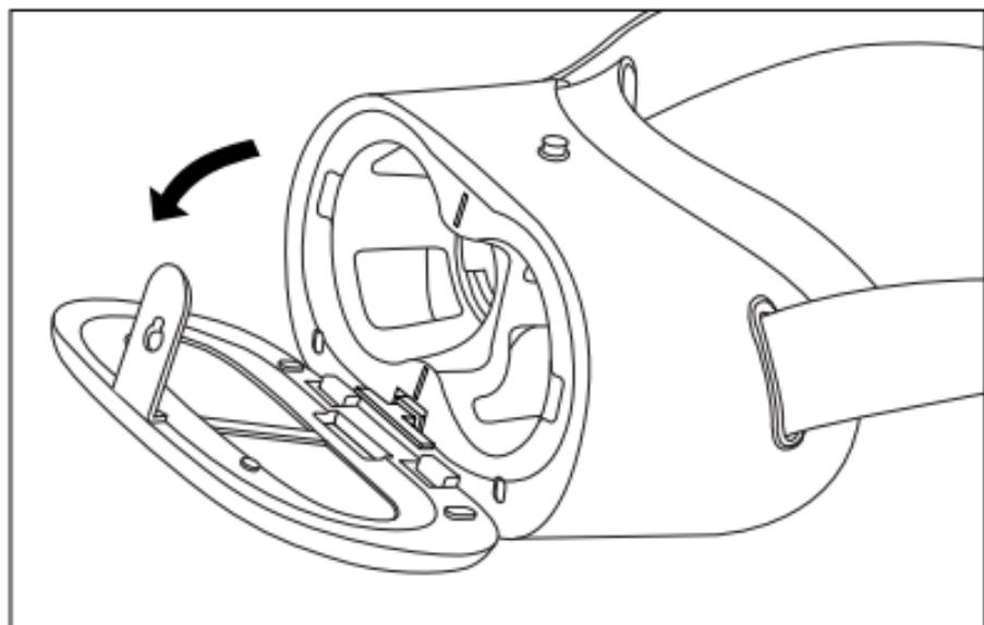
根据手机大小，调整档位拨片至合适档位。前压拨片并上下调整，底部对应6吋手机，顶部对应5吋手机，中间档位对应5.5吋手机，其他屏幕尺寸手机按照临近档位摆放即可。
